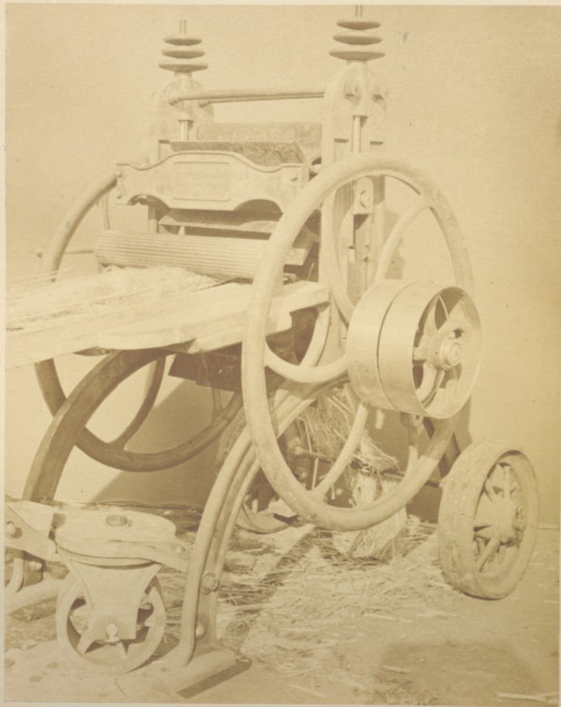
SCAVEZZATRICE VEDUTA DI FRONTE NELLA PROPORZIONE DI UN DECIMO DELLA SUA NATURALE DIMENSIONE.
