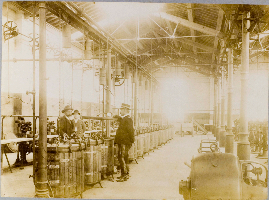
Batteria di autoclaves di rame (caldaie di 2. a cottura) per la sterilizzazione a 120. o delle scatolette
