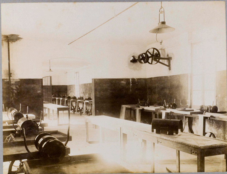
Parte dell'officina per il pulimento a mano ed a macchina delle scatolette già sterilizzate
